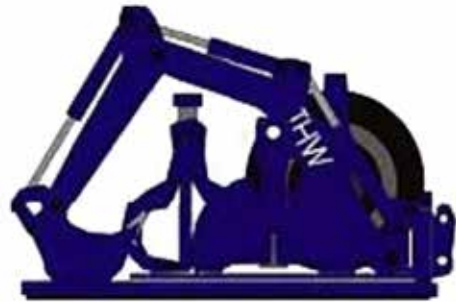
Frontarm mit Schnellwechseleinrichtung sowie Anbaugeräte auf dem Transportgestell
